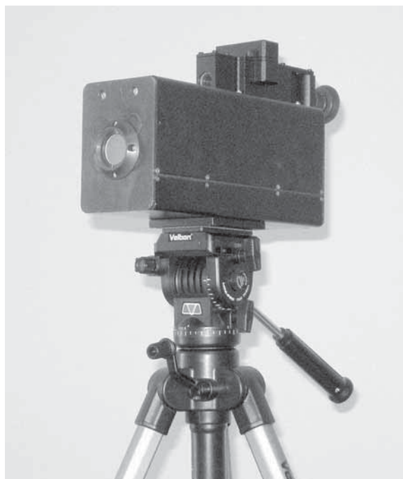
Рис. 4. Общий вид портативного Фурье-спектрометра с неохлаждаемым пироэлектрическим фотоприемником
