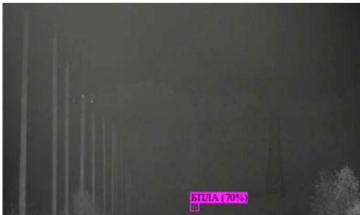
Рис. 2. Распознавание БПЛА на расстоянии 500 м с фокальным расстоянием 114,5 мм в ИК-диапазоне на фоне деревьев в дождливую погоду
