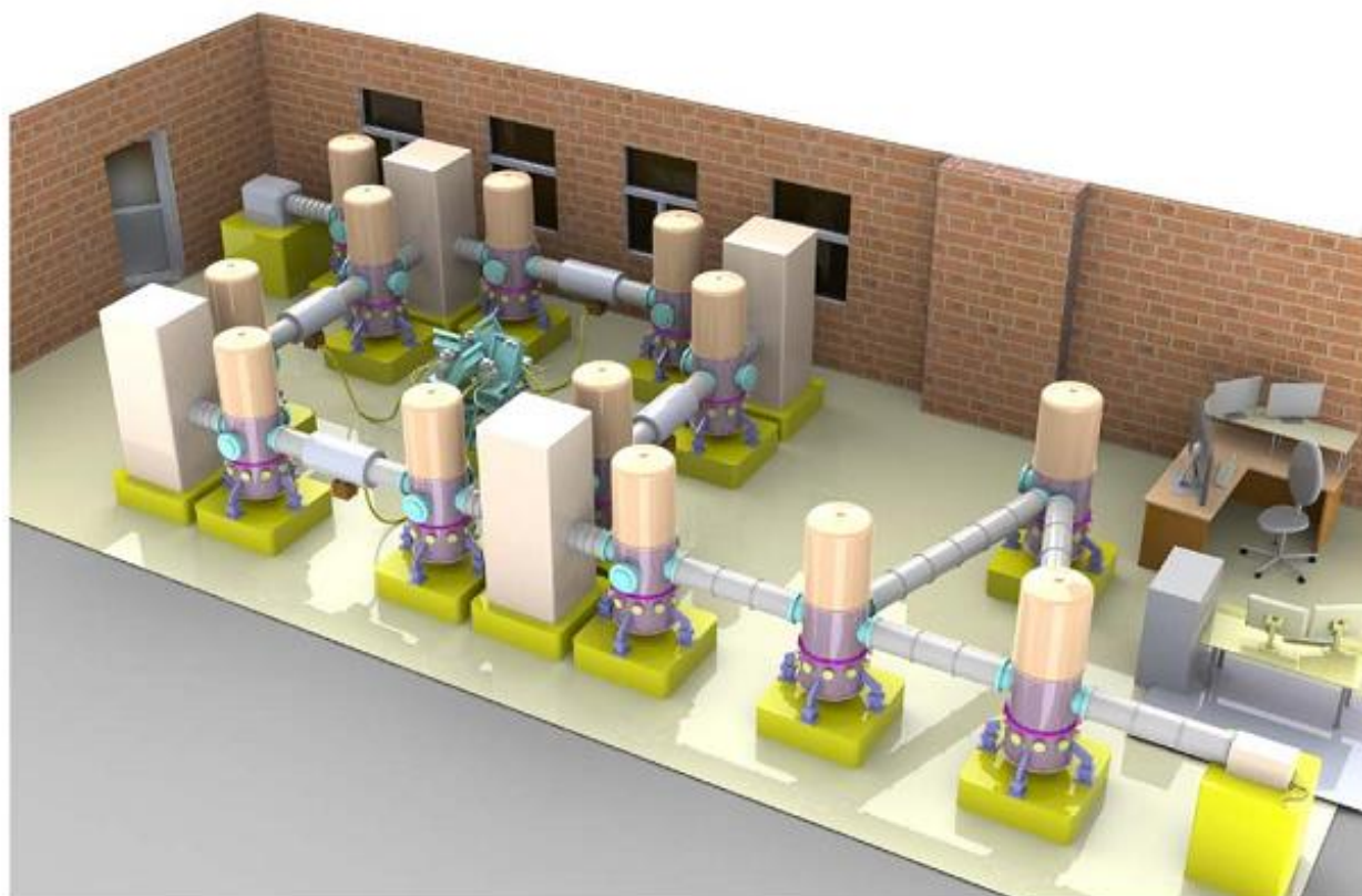
Рис. 3. Трехмерная модель лазерной интерференционной гравитационной антенны.
