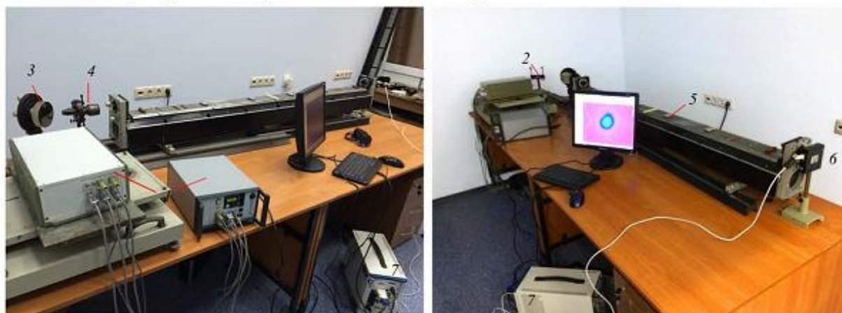
Рис. 5. Внешний вид макета для регистрации гравитационных волн: 1 — Nd:YAG лазер с длиной волны \lambda = 1064 нм, 2 — диафрагма, 3 — зеркало, 4 — расширитель пучка, 5 — оптический резонатор, 6 — камера Ophir LW130, 7 — система сбора и обработки данных National Instruments.
