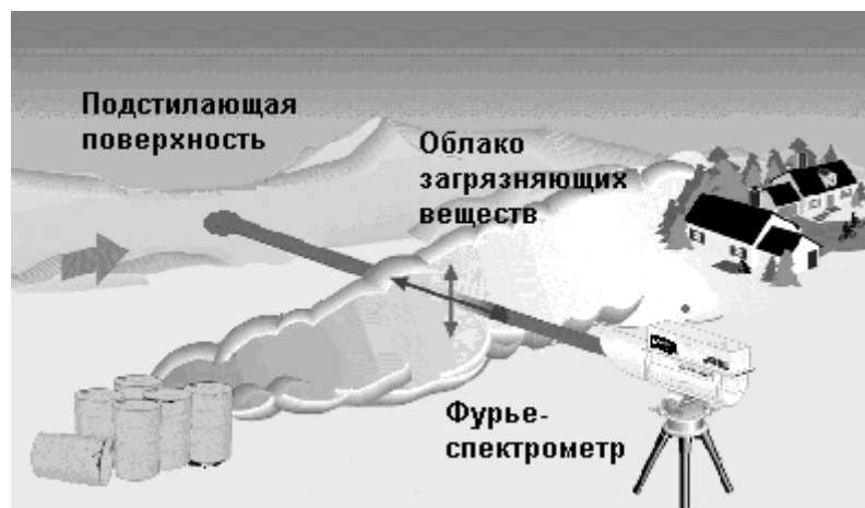
Рис.1. Иллюстрация методик обнаружения газообразных веществ а) пассивный метод регистрации; б) активный метод.
