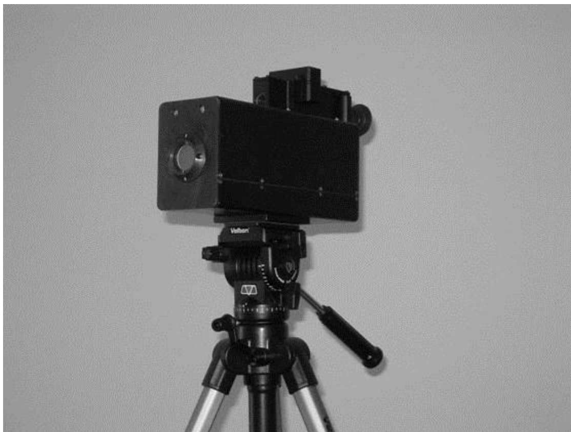
Рис. 6. Общий вид макетного ФСР с неохлаждаемым ФПУ на штативе
