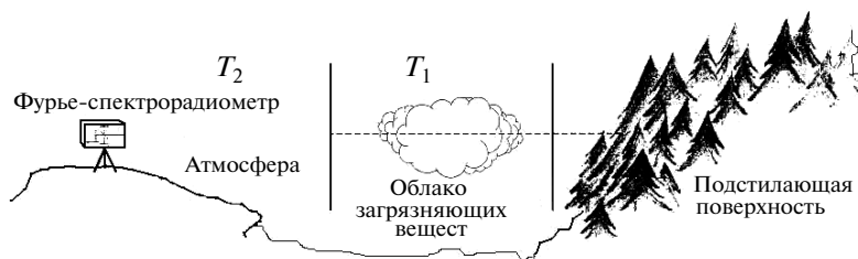
Рис. 1. Упрощенная модель регистрации спектров с помощью ФСР методом пассивной локации.
