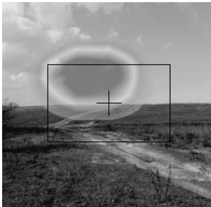
Рис. 2. Визуализация двумерного распределения облака веществ, программно наложенная на видеоряд.
