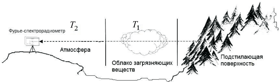
Рис. 1. Упрощенная физическая модель пассивной методики регистрации спектров:
