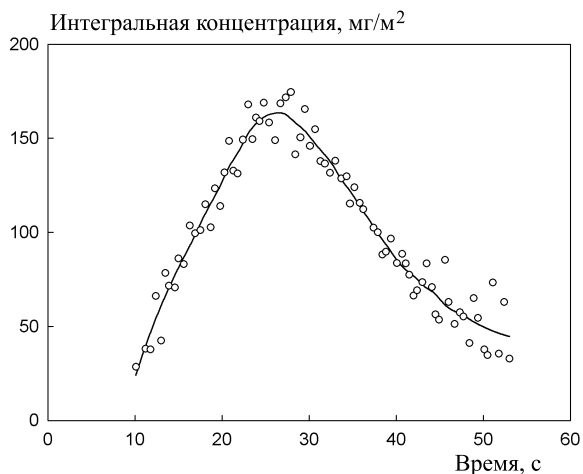
Рис. 4. График перманентной записи данных в файл по обнаружению облака паров аммиака на трассе длиной 500 м при одиночном заряде аммиака массой 80...90 г
